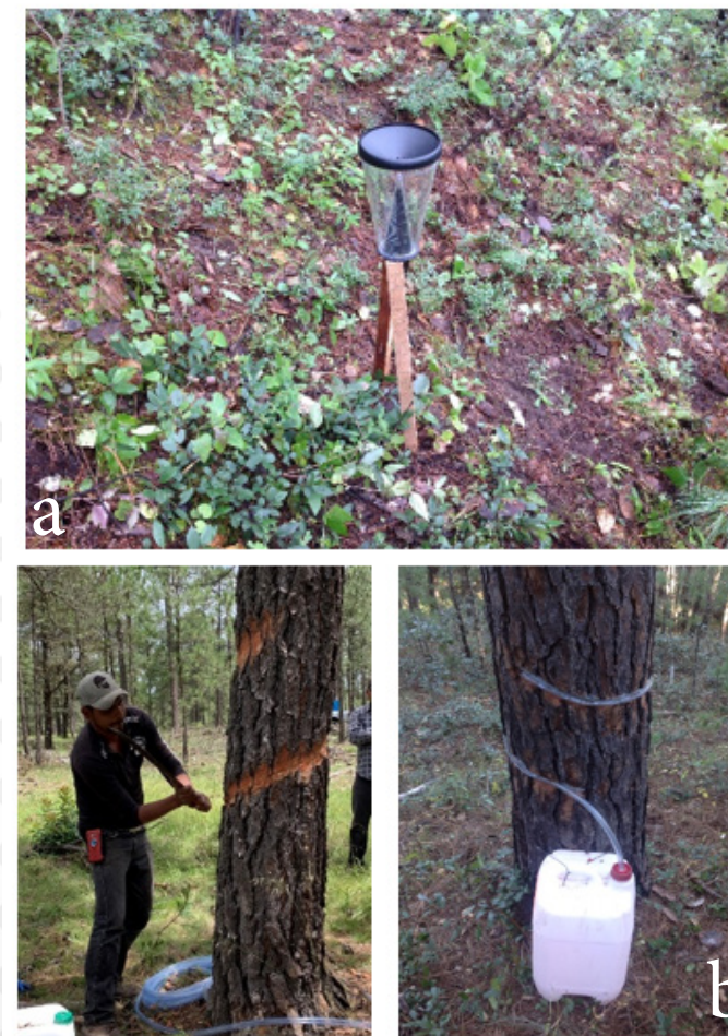
Figura 1. (a) Pluviómetro para medir precipitación directa; (b) aditamento para medir el escurrimiento fustal en árbol de pino.
