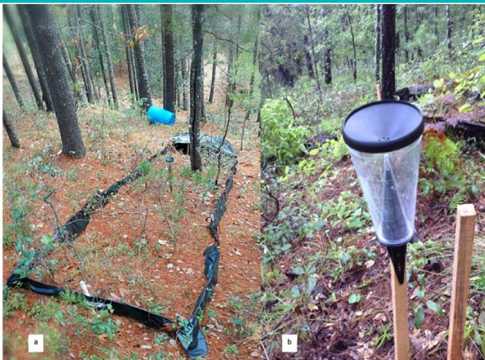
**Figura 1.** Sub-parcelas para el monitoreo de escurrimiento superficial y pluviómetros utilizados para la medición de la precipitación
